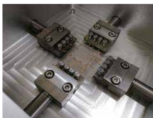
凝胶双轴拉伸试验
