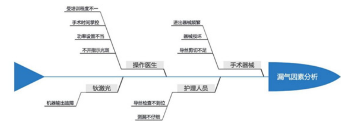
图3 镜子漏气损坏鱼骨图
